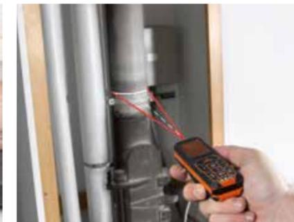
Продолжительный режим измерения с определением мин / макс значения
